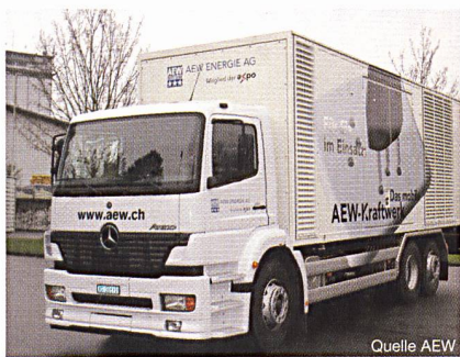
Notstromgruppe für 650 kVA mit Partikelfilter
