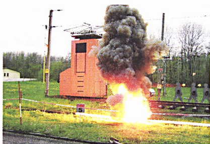
Demonstration einer Kabelverletzung (Bilder: cef).
