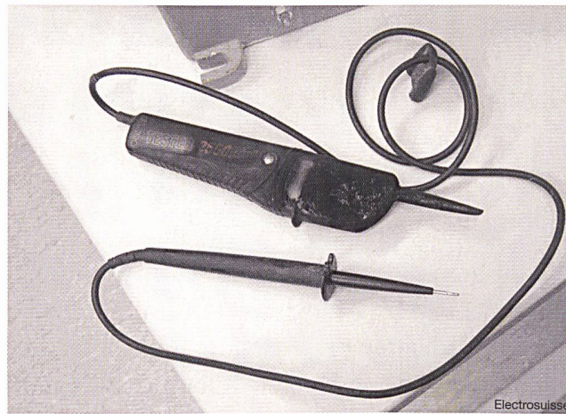
Bild 4 Der Netzelektriker löste mit dem Duspols einen Kurzschluss aus
