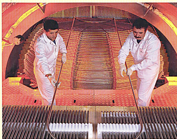
Fertigung von Dampferzeugern bei Areva (Bild Areva).
