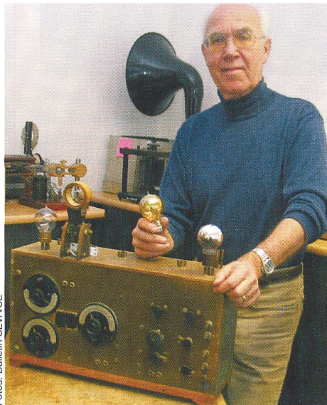
Eduard Willi mit zwei Highlights der Sammlung Acklin. Links: demontierbare (!) UKW-Sendetriode, Baujahr 1939, wassergekühlt, von Brown Boveri (BBC). Dieser Röhrentyp war zwar technisch originell, schaffte den kommerziellen Durchbruch aber nicht. Damit teilte er das Schicksal vieler anderer Schweizer Röhrentypen, weil der Schweizer Markt zu klein und die ausländische Konkurrenz zu gross waren. – Rechts: Schweizer Rundfunkempfänger, Fabrikat Schneider, La-Chaux-de-Fonds, Baujahr ca. 1924. Sehr seltenes Gerät, leider unvollständig, nicht restauriert. – Eduard Willi avec deux objets particulièrement intéressants de la collection Acklin. A gauche: triode d'émission WAF démontable (!), dant de 1939, refroidissement par eau, de Brown Boveri (BBC). Ce type de tube est techniquement original mais n'a pas réussi à s'imposer sur le plan commercial. Il a partagé le destin de nombreux autres tubes suisses car le marché suisse était trop petit et la concurrence étrangère trop forte. – A droite: récepteur radio suisse, marque Schneider, La Chaux-de-Fonds, année de construction vers 1924. Appareil très rare, malheureusement incomplet et non restauré.
