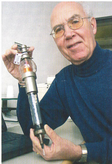
Eduard Willi mit zwei Highlights der Sammlung Acklin. Links: demontierbare (!) UKW-Sendetriode, Baujahr 1939, wassergekühlt, von Brown Boveri (BBC). Dieser Röhrentyp war zwar technisch originell, schaffte den kommerziellen Durchbruch aber nicht. Damit teilte er das Schicksal vieler anderer Schweizer Röhrentypen, weil der Schweizer Markt zu klein und die ausländische Konkurrenz zu gross waren. – Rechts: Schweizer Rundfunkempfänger, Fabrikat Schneider, La-Chaux-de-Fonds, Baujahr ca. 1924. Sehr seltenes Gerät, leider unvollständig, nicht restauriert. – Eduard Willi avec deux objets particulièrement intéressants de la collection Acklin. A gauche: triode d'émission WAF démontable (!), dant de 1939, refroidissement par eau, de Brown Boveri (BBC). Ce type de tube est techniquement original mais n'a pas réussi à s'imposer sur le plan commercial. Il a partagé le destin de nombreux autres tubes suisses car le marché suisse était trop petit et la concurrence étrangère trop forte. – A droite: récepteur radio suisse, marque Schneider, La Chaux-de-Fonds, année de construction vers 1924. Appareil très rare, malheureusement incomplet et non restauré.
