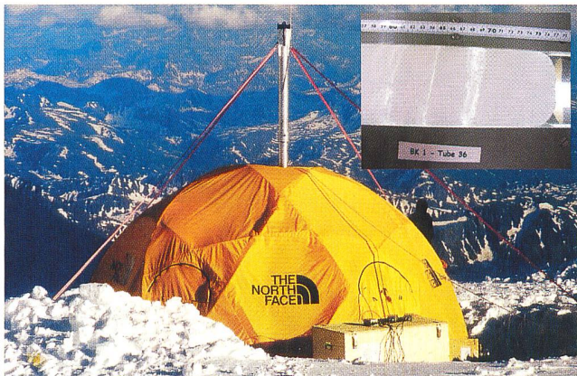
Das Bohrzelt auf dem Belukha-Gletscher. Im kleinen Bild ist der markante Temperaturanstieg sichtbar: Der Eiskern enthält durchsichtige Schmelzschichten, die sich bilden, wenn die Lufttemperatur höher als null Grad ist. Da beginnt der Schnee an der Gletscheroberfläche zu schmelzen (Fotos: PSI).
