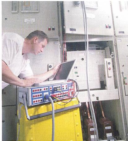
Aus der Primärprüfungstechnik zeigen wir Ihnen das CPC 100, das multifunktionale Prüfsystem für die Inbetriebnahme und die Wartung von Umspannanlagen. Der CT Analyzer, das ideale Werkzeug für die Prüfung von Stromwandlern, und der FR Analyzer (Swept Frequency Response Analyzer) für die Diagnose von Wicklungsdeformationen an Leistungstransformatoren runden das Produktspektrum ab.
