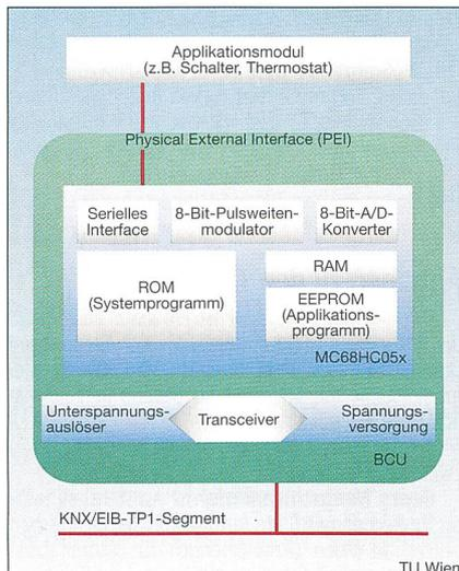
Bild 5 KNX/EIB-Gerät
