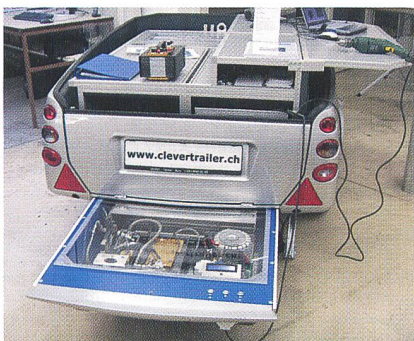
Der Brennstoffzellenstapel generiert 230 Volt Wechselstrom für unterwegs
