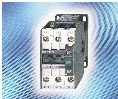
Die neue Kondensatorschütz-Baureihe ist speziell für verdrosselte Blindleistungskompensations-Anlagen geeignet. Sie verzichtet auf Vorladewiderstände, da deren Funktion bereits von der Filterkreisdrossel erfüllt wird.
