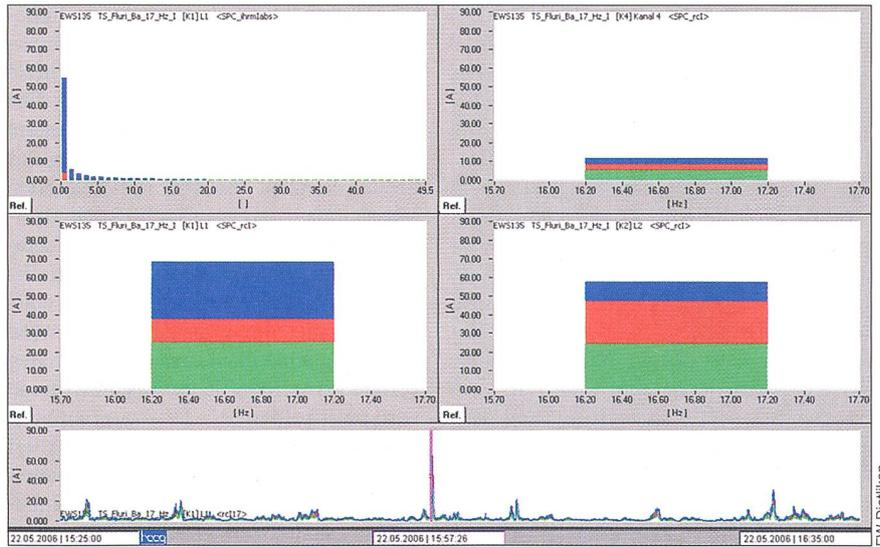
**Bild 3** Wie sich der Bahnrückstrom in der Transformatorstation des EW Dietlikon verteilt
