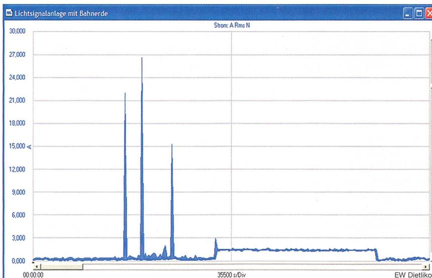
Bild 7 Bahnrückströme, die in die Lichtsignalanlage fließen
