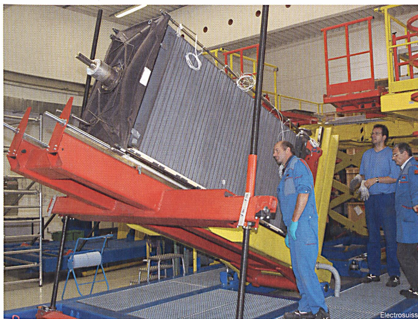
Bild 5 Fertigung des Brennstoffzellenstapels bei der MTU in München Die einzelnen Zellen werden zuerst aufeinandergeschichtet und fixiert. Dann wird der Stapel abgelegt – in die Lage, wie er im System eingebaut wird.
