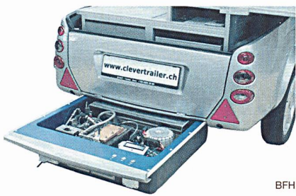
Bild 4 Clevertrailer mit Brennstoffzelle
