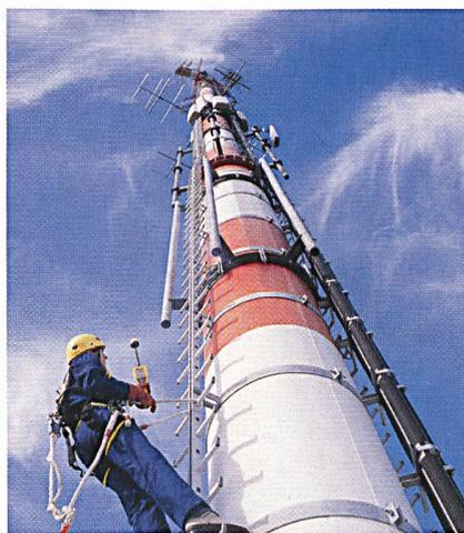
Feldstärkemessung mit dem Broadband-Field-Meter NBM-550 von Narda
