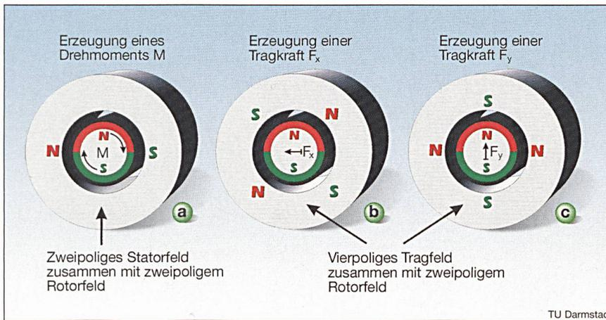
Bild 3 Anschauliche Erklärung der Querkräfte in lagerlosen Motoren
