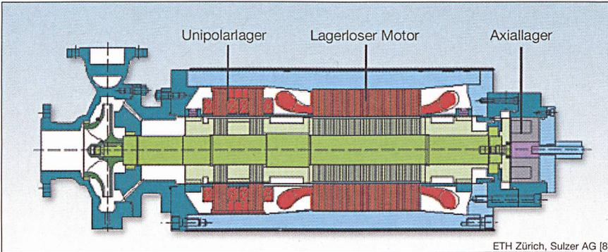
Bild 7 Lagerlose Spaltröhropumpe
