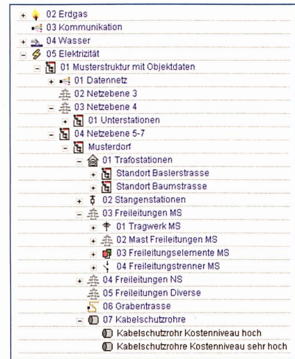
Bild 2 Der Hierarchiebaum kann nach individuellen Bedürfnissen erstellt werden. Jedes Anlageobjekt wird in Bezug auf die Preise, Mengen, Eigentümer usw. gepflegt. Für jedes Anlageobjekt werden Strukturteile, das Baujahr sowie weitere technische Daten mittels (jährlichen) Datenimports aus dem GIS transferiert (Quelle Encontrol).
