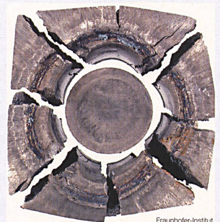
Aufeinanderprallende Metallplatten simulieren einen Meteoriteneinschlag. Einige wenige der Mikroben, die sich darauf befinden, überleben den 400000-fachen Druck
