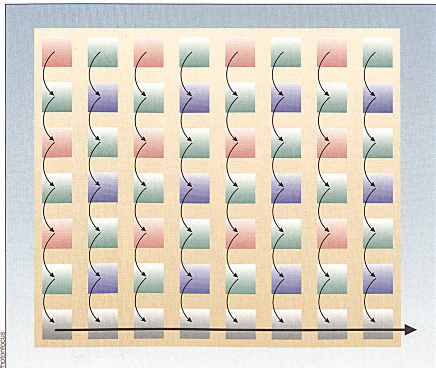
Bild 1 Auslesetechnik beim CCD-Farbsensor.
