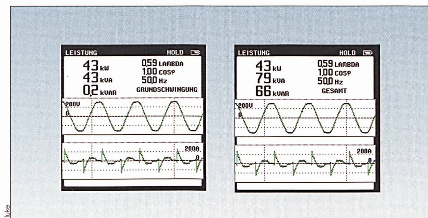
Bild 5 Leistungsmessung Links ohne, rechts mit Berücksichtigung der Oberschwingungen.
