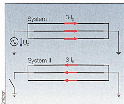
Bild 4 Strom-Strom-Methode zur Messung der mutuellen Kopplung.
