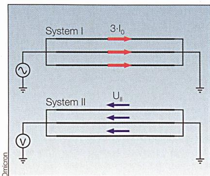
Bild 3 Strom-Spannungsmethode zur Messung der mutuellen Kopplung.
