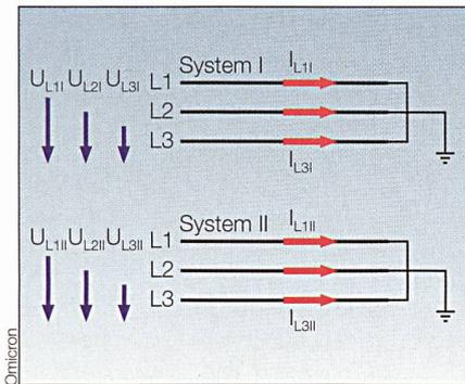
Bild 2 Zwei 3-phasige Systeme mit mutueueller Kopplung.
