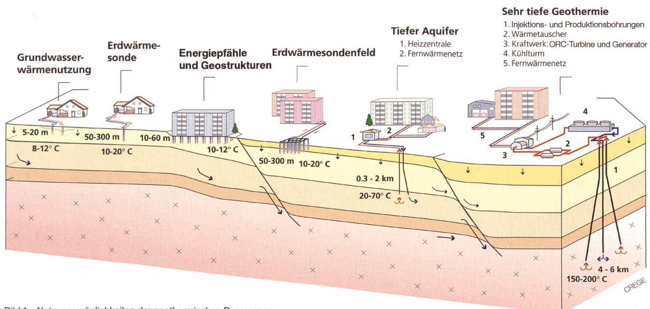
Bild 1 Nutzungsmöglichkeiten der geothermischen Ressourcen.
