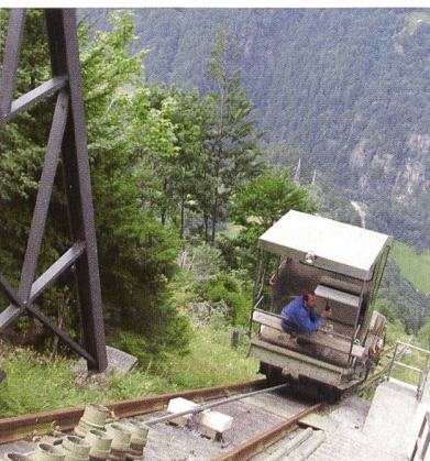
Bild 3 Standseilbahn als Zufahrt zum Wasserschloss.
