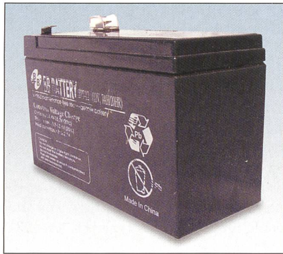
Bild 12 Im EGK wird ein weitverbreiteter Blei-akku eingesetzt.
