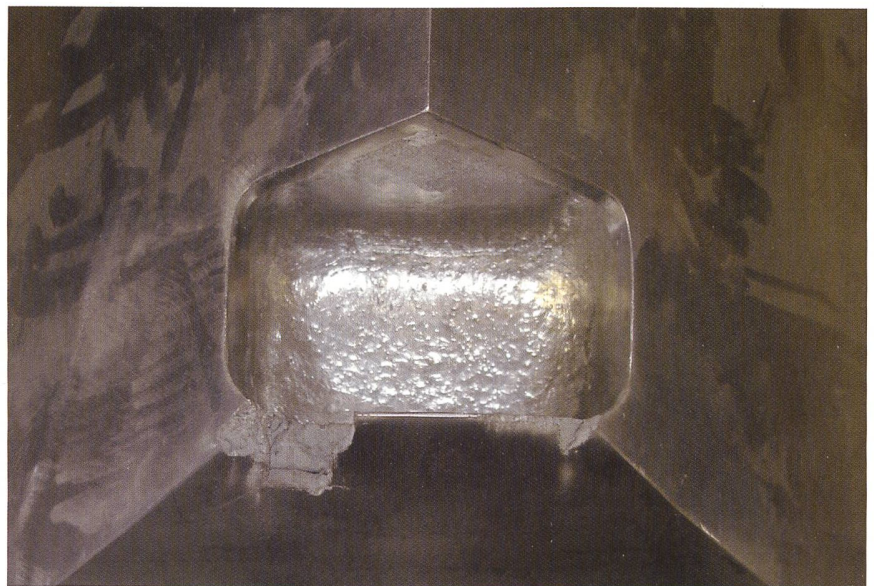
Bild 5 Das Schutzdach, das die benachbarte Düse schützt, wird durch die Tropfen beschädigt.
