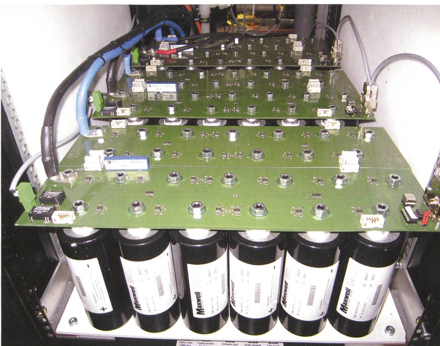
Bild 4 Superkapazitäten liefern kurzfristige Energie.
