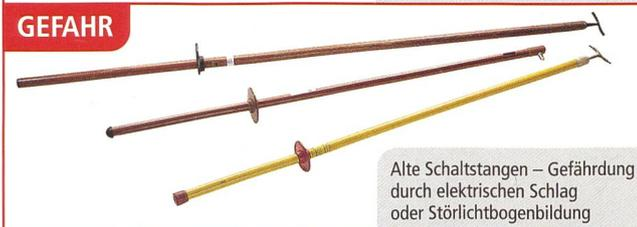
Alte Schaltstangen – Gefährdung durch elektrischen Schlag oder Störlichtbogenbildung
