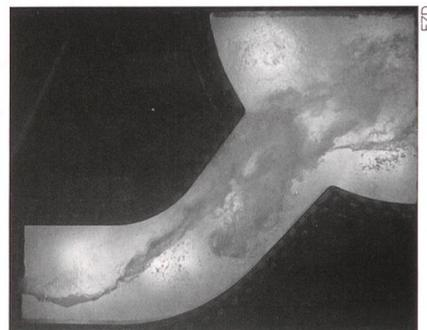
Dampf-Wasser-Strömung bei 5 Megapascal (50-facher Normaldruck) und 264 °C.
