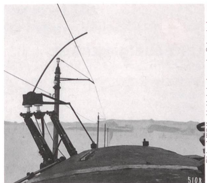
Rutenstromabnehmer System MFO; Bestreichung des Fahrdrabts schräg von der Seite.
