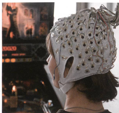
Eine Testperson steuerte über das sogenannte Berliner Brain Computer Interface (BBCI) einen Flipperautomaten in Echtzeit – allein durch die Kraft seiner Gedanken.
