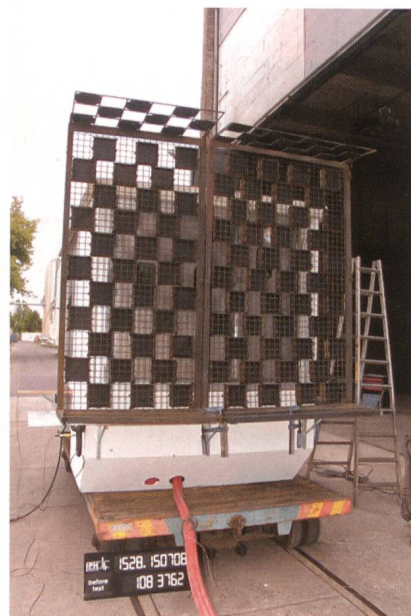
Bild 3 Prüffeld fabrikfertige Station, nicht begehbar, vor «A-Schuss».
