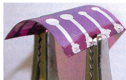
Figure 6 Cellules solaires de laboratoire déposées sur un substrat flexible. La couche violette est constituée d'un colorant photographique de type cyanine. Chacune des quatre surfaces circulaires définit une petite cellule photovoltaïque.
