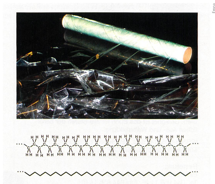
Figure 1 Feuille de polyéthylène (PE) enroulée. En dessous, la structure chimique de la chaîne polymérique constituée d'atomes de carbone et d'hydrogène est illustrée. Les traits reliant les atomes représentent les liaisons chimiques entre atomes. La notation chimique simplifiée est donnée en bas.
