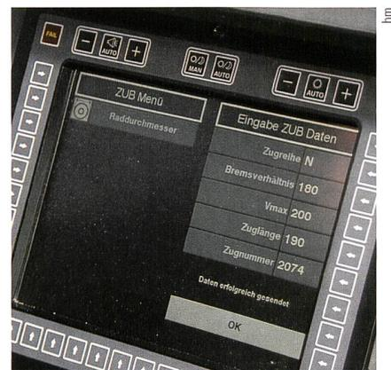
Vor der Abfahrt muss der Lokführer jeweils die Daten für das Zugbeeinflussungssystem eingeben. Auf diesen Werten beruhen die Überwachungskriterien der Zugsicherung.
