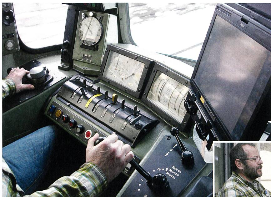
Unterwegs mit der Re 420, Baujahr 1966. Lokführer Peter Dürrenmatt bedient mit der rechten Hand den Fahrschalter: Nach oben erhöht sich die Zugkraft, nach unten wird die elektrische Bremse betätigt (Rekuperation ans Netz). Die linke Hand ist auf dem sogenannten Führerbremssventil, damit jederzeit die Druckluftbremse betätigt werden kann; diese presst die Bremsklötze ans Rad.
