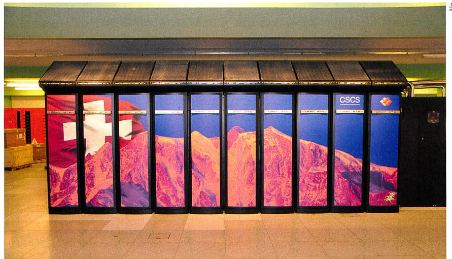
Bild 1 Der Monte Rosa am CSCS in Manno. Der schwarze Kasten rechts ist die Freon-Kühleinheit.
