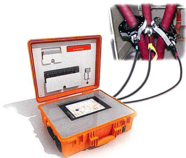
Der LPD-Monitor unterscheidet zwischen Teilentladungen und Rauschen.
