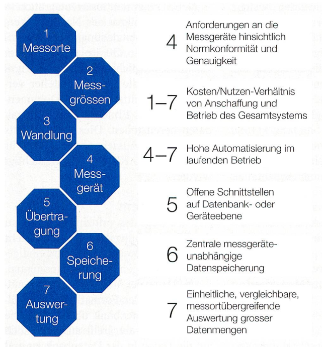
Bild 1 Wichtige Kriterien bei der Konzeption eines Spannungsqualitäts-Überwachungssystems.
