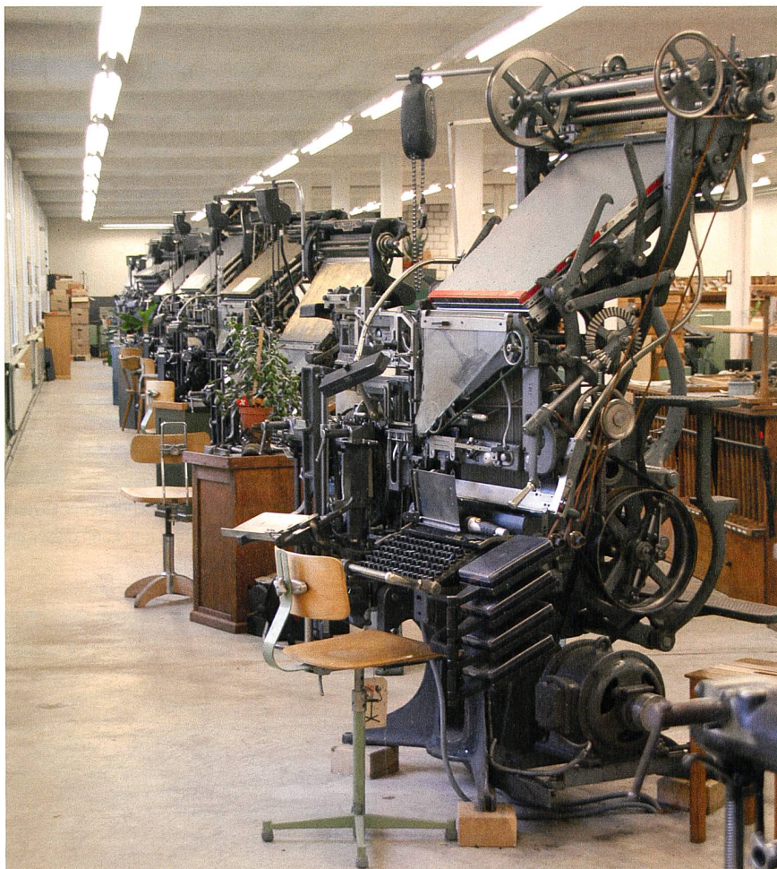
Bleisatzmaschinen – erfunden im späten 19. Jahrhundert – lieferten die grossen Textmengen für Zeitungen und Zeitschriften. Im Typorama Bischofszell (Bild) stehen Modelle ab Baujahr 1912 bis zu den letzten Modellen aus den 1980er-Jahren. So oder ähnlich wie auf diesem Foto sah es zurzeit der Bulletin-Gründung im Jahre 1910 in vielen grösseren Zeitungs- und Zeitschriftenbetrieben aus.
