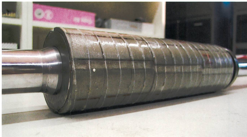
Bild 5 Läufer des Funktionsmusters mit Bandage.
