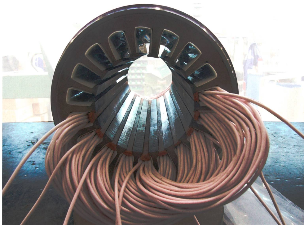
Bild 4 Ständerblechpaket des Funktionsmusters, teilweise bewickelt.
