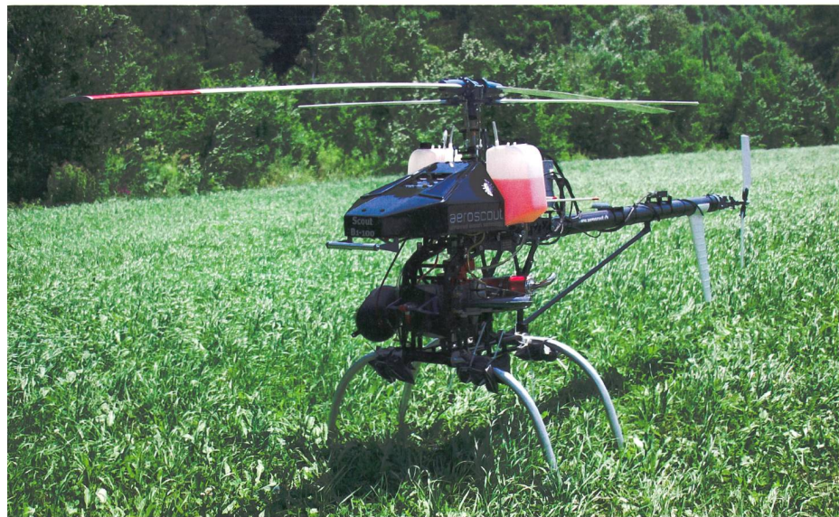
Bild 2 Der Scout B1-100 UAV-Helikopter während eines Testflugs in der Schweiz mit einem Bleigewicht von rund 15 Kilo.
