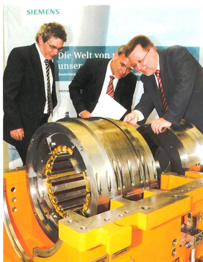
Un segment de la nouvelle installation de recherche sur les paliers magnétiques.
