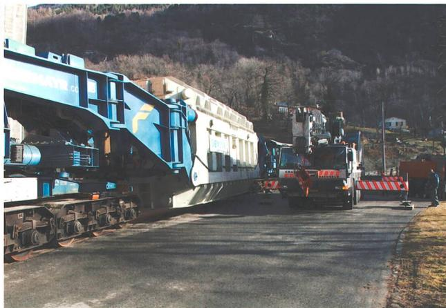
**Bild 2** Wegen des hohen Gewichts konnten die Transporte nicht auf der Strasse erfolgen. Der Bahntransport war der grösste und schwerste, der jemals durch den Gotthardtunnel gerollt ist.
