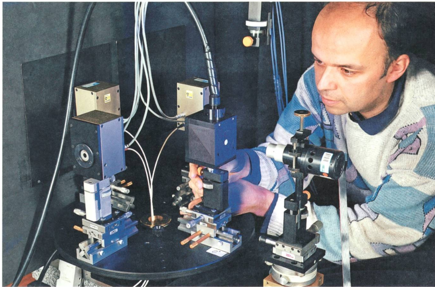
Figure 2 Mesure de l'intensité lumineuse d'une LED bleue. En plus des trois photomètres de référence, un spectroradiomètre permettant de corriger l'erreur due à une mauvaise adaptation spectrale est utilisé pour mesurer la distribution spectrale de la LED.
