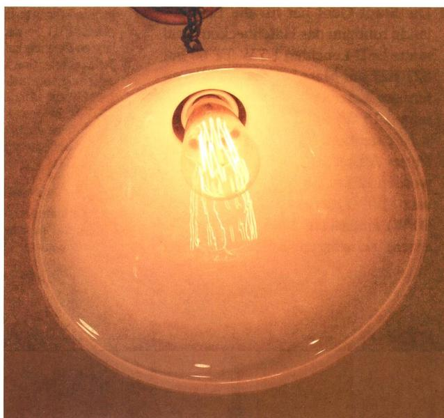
**Bild 3** Pure Nostalgie: Eine Pendelleuchte aus dem Jahre 1920, bestückt mit einer seit 1995 wieder durch Righi Licht gebauten Edison-Lampe Deluxe P64 klar mit langgezogener Glühwendel aus Wolfram: 40 W, 250 lm, 6,25 lm/W, mittlere Betriebsdauer 4000 h.<sup>6)</sup>
