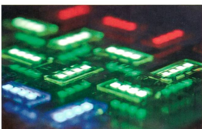
OLED rouges, verts et bleus avec une surface active de 2 \times 2\text{ mm} pour des tests de performance.
