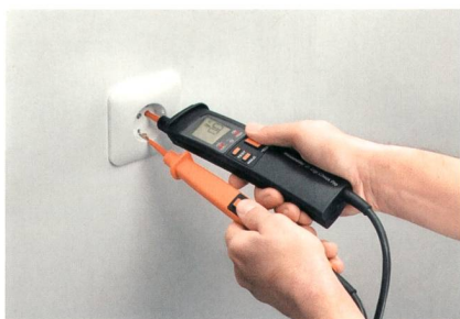
Ein versehentliches Auslösen des FI-Schuttschalters beim Prüfen ist ausgeschlossen.
