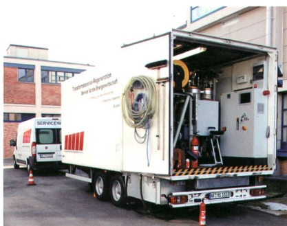
Die mobile Transformatorenöl-Regenerationsanlage inklusive Online-Monitoring.
