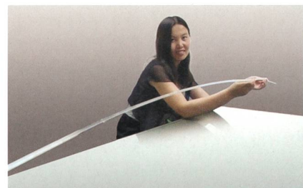
Das Skelett des Glasschwamms aus Siliziumdioxid ist biegsam und erinnert an einen Glasfaserstab.
