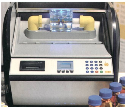
Zahlreiche Diagnosegeräte, wie hier für die Transformatorölnachanalyse, unterstreichen die Tatsache, dass die Versorgungs- und Ausfallsicherheit keine Selbstverständlichkeit ist.
