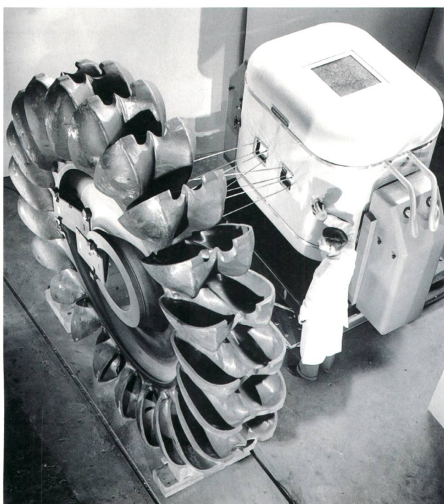
Bild 3 Zerstörungsfreie Prüfung einer Pelton-turbine mittels Zweistrahlbetatron. Die Strahlungsfelder sind durch Metallstäbe visualisiert. Auf der Rückseite des Turbinenrades sind die Filmkassetten für Fotoaufnahmen befestigt.
