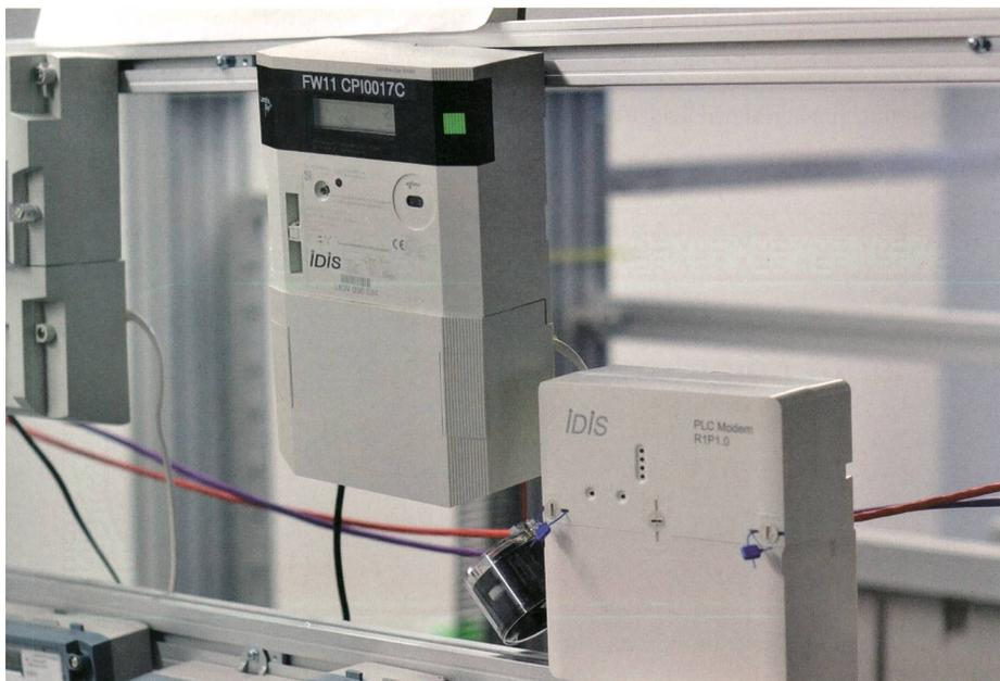
**Bild 1** Beispiel eines Final-Interoperability-Tests bei einem Idis-Mitglied.
