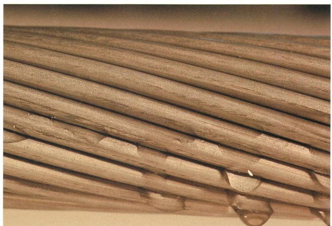
Bild 4 Wassertropfen auf einem besprühten neuen Seil ohne Behandlung (links) und mit Aufrauung (rechts).
