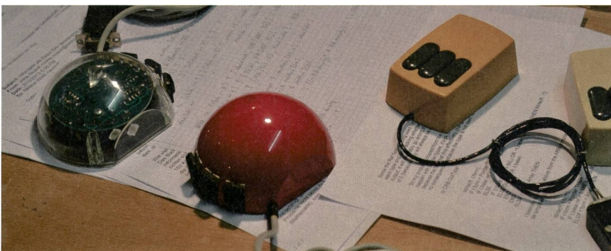
Als Mäuse noch keine Mikroprozessoren benötigten: Schweizer Dépraz-Mäuse (links) aus den 1980er-Jahren treffen auf dem Wirthschen Arbeitstisch auf kalifornische Xerox-Mäuse.
